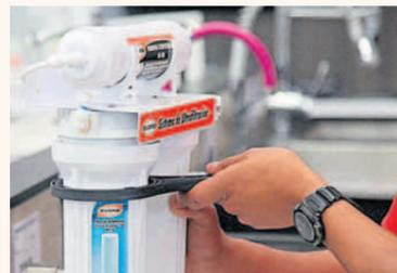
6. Encaje el filtro en el equipo y luego ajuste girando con la ayuda de la herramienta que viene incluida.
